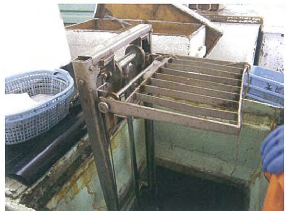
リフトを上げた状態(魚倉口)
